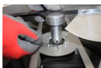
3 volver a apretar el tornillo bloqueador del eje
