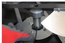
1 Aflojar el tornillo bloqueador del eje
