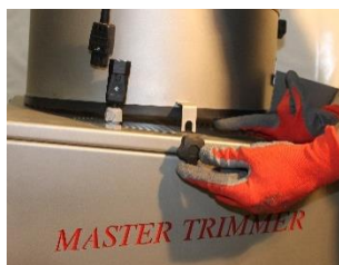
1. Colocar el contenedor principal encima de la rejilla y colocar los dos tornillos de sujeción.
