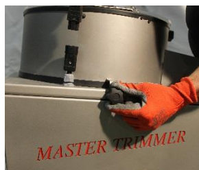
2. Apretar los dos tornillos de sujeción del contenedor y conectar el motor superior a la corriente.
