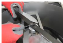
2 Aflojar el tornillo central del eje
