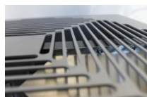
4 Bajar la rejilla y comprobar que las cuchillas están a la distancia deseada (importante dejar 2mm Seguridad entre rejilla y cuchillas.)
