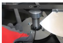
1 Aflojar el tornillo bloqueador del eje
