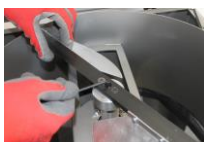
2 Aflojar el tornillo central del eje
