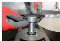
3 Ajustar las cuchillas a la altura deseada
