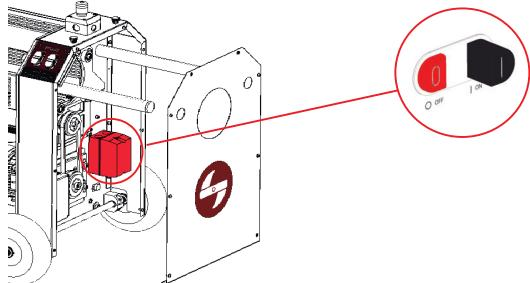
**6** Une fois la protection moteur remontée, placez la protection latérale et fixez-la avec les vis et la clé allen N° 5.
