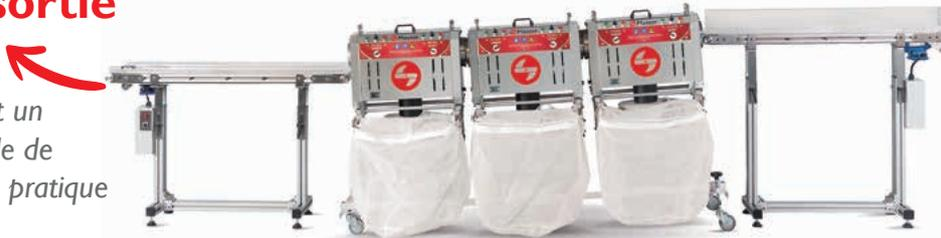
Grâce au régulateur de vitesse, la cadence d'avancement peut être ajustée, permettant à l'opérateur d'identifier les fleurs abîmées ou non taillées.
